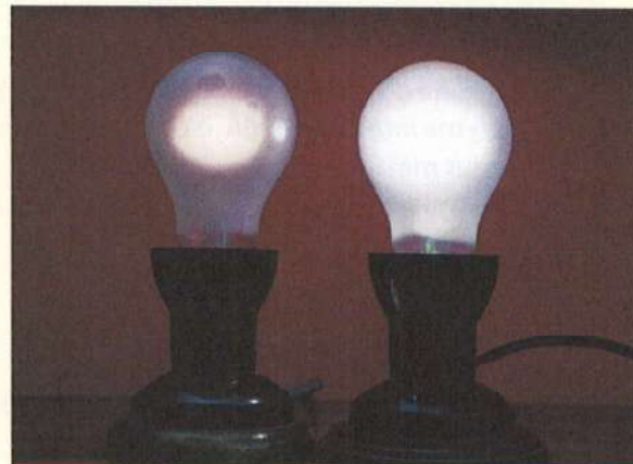
Figura 13.7 Të dyja këto llamba lidhen në rrjet, por njëra e ka rezistencën më të madhe se tjetra. Për pyetjen 6.
