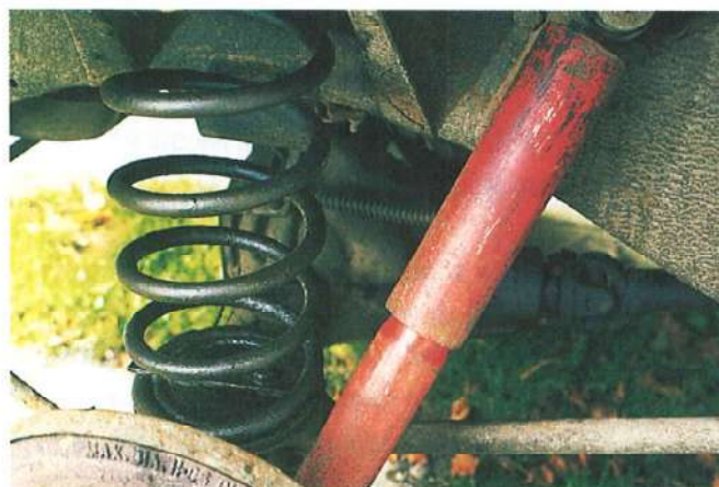
Figura 18.28 Sustat dhe amortizatorët e makinës formojnë një sistem të frenuar.
