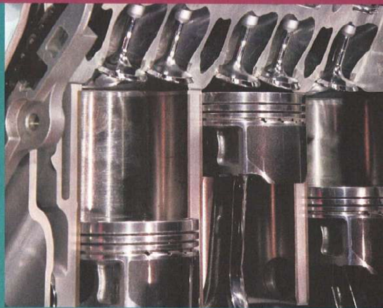
Figura 18.1 Pistonat e motorit të makinës lëkunden lart e poshtë gjatë punës së tij.
