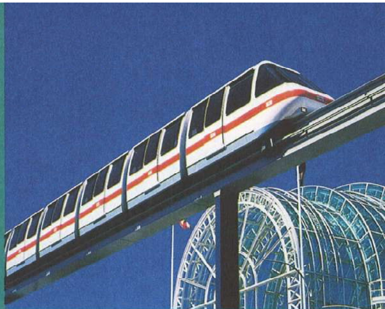
Figura 15.1 Ky tren i shpejtësive të mëdha mbahet pezull nga elektromagnetët, në mënyrë që të shmanget fërkimi me shinat.
